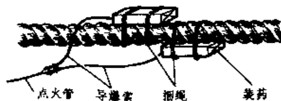
图 6—14 用两个集团装药炸断钢索
