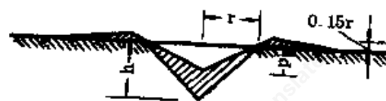
图 5—5 抛掷漏斗坑可见深度
