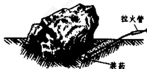
图 10—6 向一侧飞散石块
